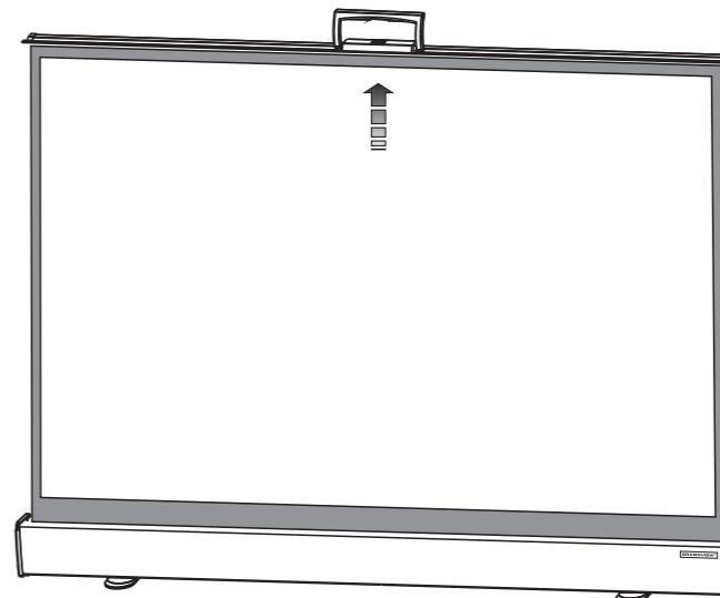
五、使用完毕手和银幕时，轻压提手基座直至完全收合，听到“哒”声。
